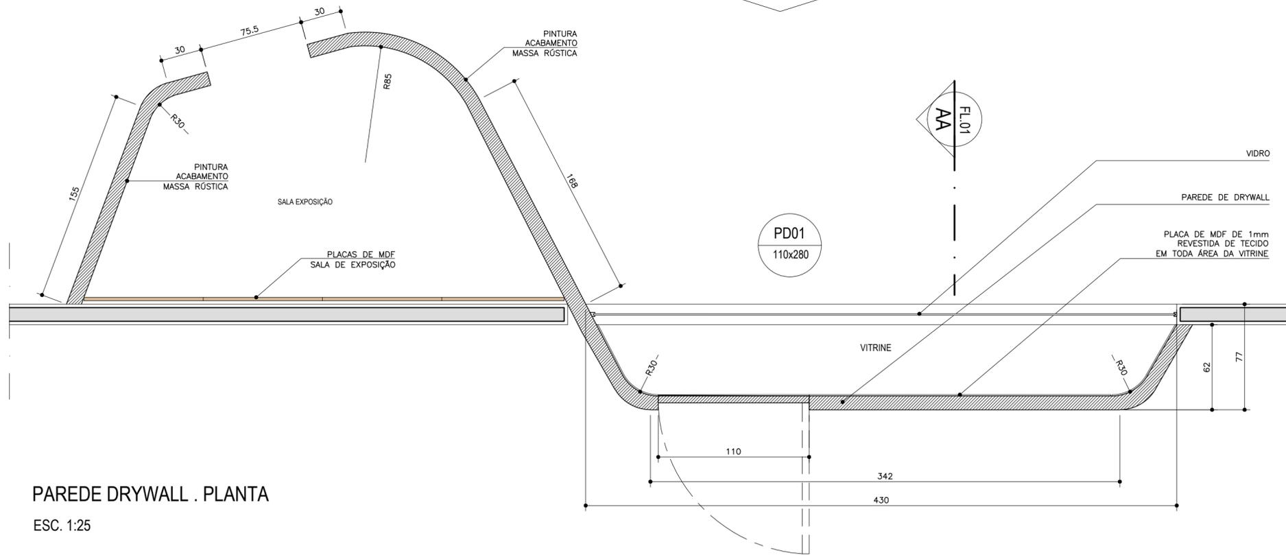
PAREDE DRYWALL . PLANTA
