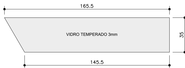
VIDROS EXPOSITOR VINIL . PLANTA ESC. 1:20
