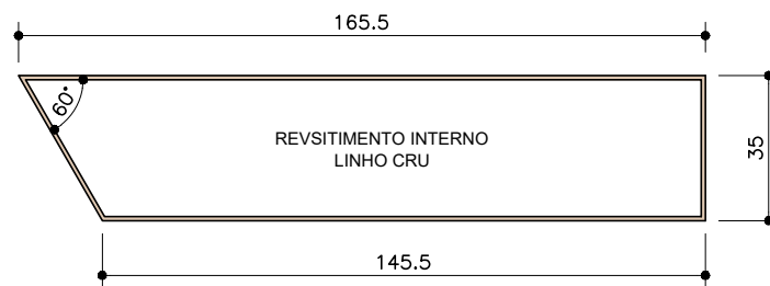
EXPOSITOR VINIL . PLANTA CAIXAS INTERNAS ESC. 1:20
